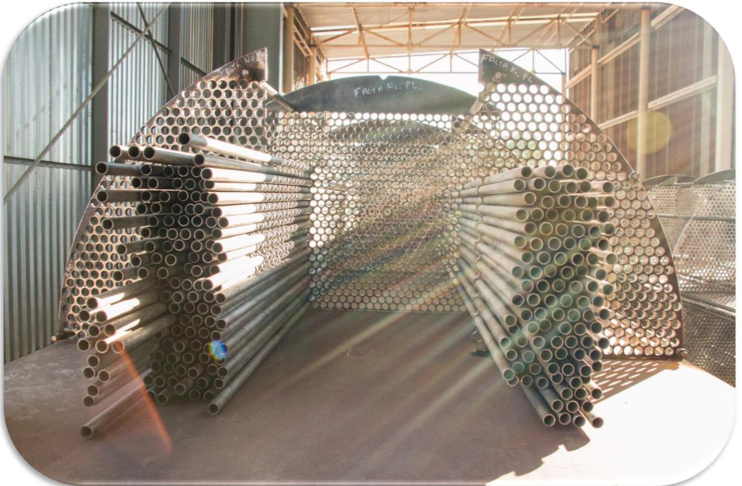
Entubado de Haz para Cambiador de Calor.
