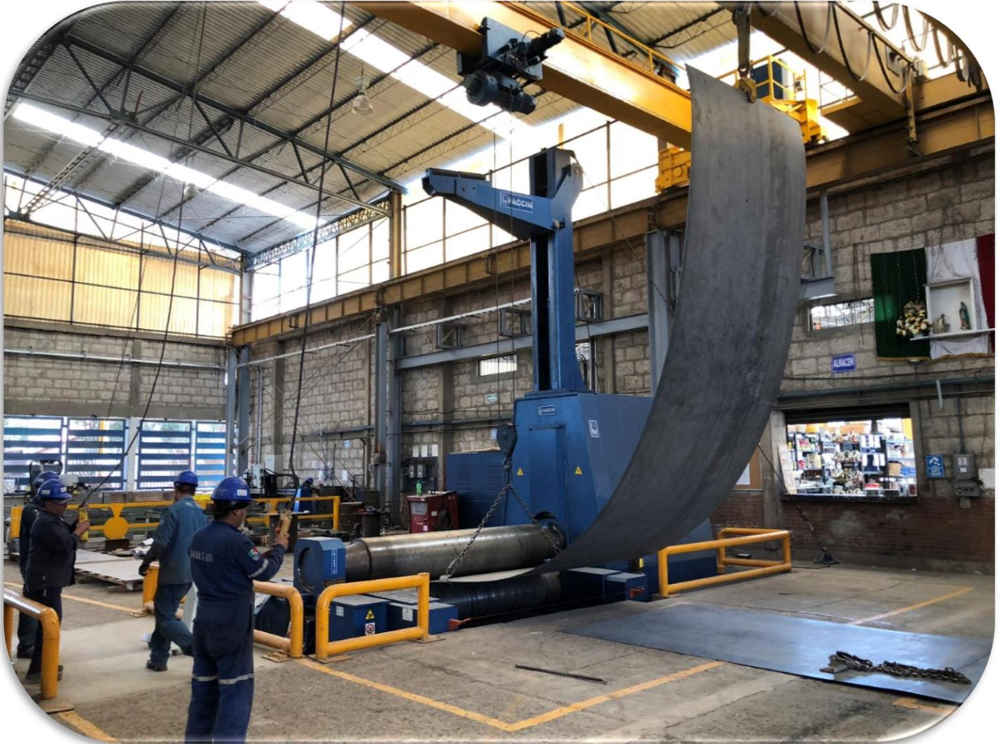
Rolado de placa en longitud de 12m (40') para tanques de almacenamiento.
