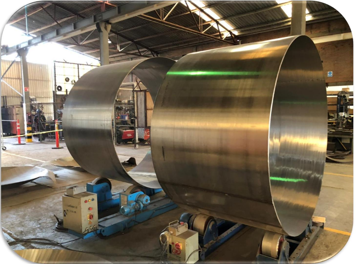
Fabricación en acero inoxidable Dúplex con acabado tipo grado alimenticio.
